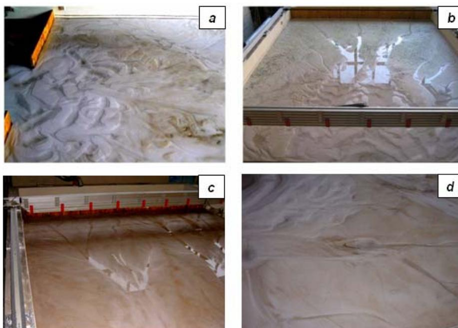
**Figura 2.** Topografia della laguna osservata nella Prova 1 dopo: a) 1200 cicli; b) 6000 cicli; e nella Prova 2 dopo: c) 6000 cicli; d) 7710 cicli.
