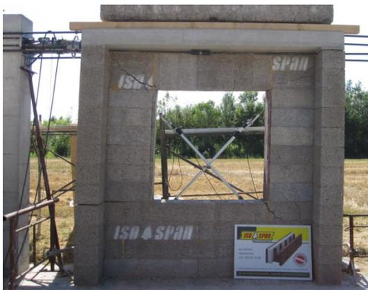
La campagna sperimentale ha fornito importanti informazioni riguardo il comportamento meccanico e la duttilità delle pareti. E' stato derivata una teoria analitica per la verifica di resistenza delle pareti.
